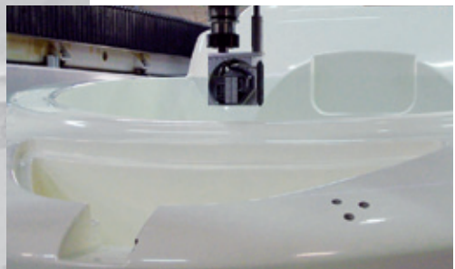
Dispositivo di tastatura laser Optical probing by radio laser probe
