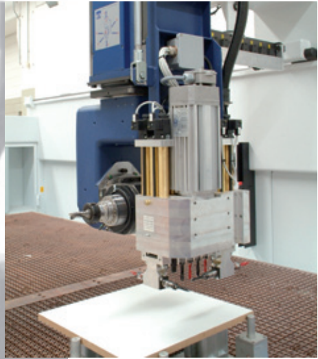
Unità operatrice a 5 assi con gruppo a forare per lavorazione pannelli
