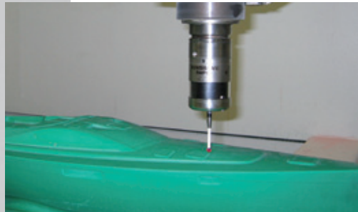
Dispositivo di tastatura meccanico Mechanical probing by radio touch probe
