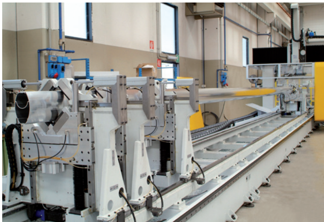
Soluzione speciale per la produzione di alberi in alluminio Special solution for sail mast production.
