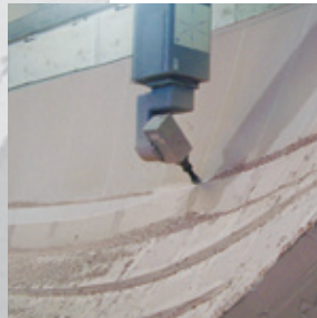
Fresatura a 5 assi ad alta velocità del rivestimento in modo da ottenere la geometria nominale fornita dal progetto CAD.
