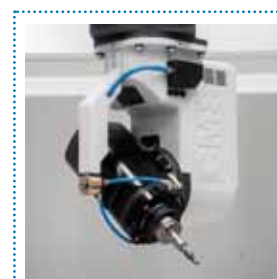
Sistema di lubrefrigerazione Flood cooling system
